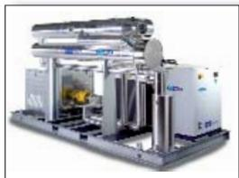
Per soddisfare richieste di trattare portate d'aria compressa maggiori, Mta ha sviluppato la gamma di essiccatori a refrigerazione DryPower Vario Twin (capacità 75-180 m<sup>3</sup>/min), offrendo una tecnologia brevettata basata sull'impiego di due inverter abbinati a due compressori frigoriferi di taglie differenti.
