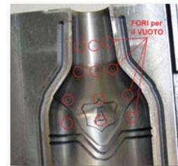
vuoto anziché "spingerla" con il "settle blow". Sostituire quasi del tutto l'uso del "settle blow" con il vuoto significa risparmiare l'85-90% dell'aria compressa necessaria a questa fase della produzione, riducendo il tempo ad essa dedicato.
