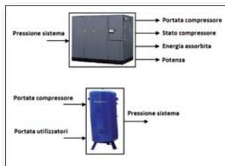
Fig. 1 - Blocchi Simulink rappresentanti un compressore load/unload e un serbatoio.
