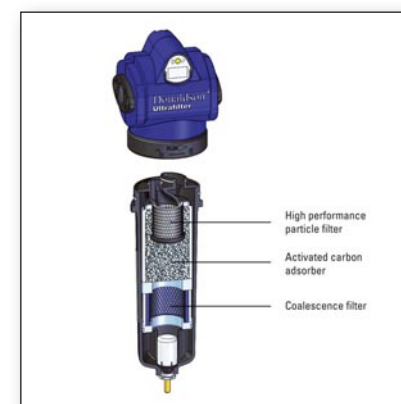
Fig. 3 - Filtro a 3 stadi Donaldson DF-T “all in one” per la filtrazione di aerosol d'olio, particolato e dei vapori d'olio, di qualità classe 1 in accordo con la Iso 8573-1:2010.
