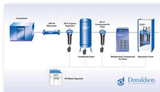
Fig. 2 - Schema di un sistema di purificazione di una centrale d'aria compressa.
