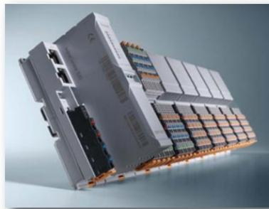
I moduli I/O, espandibili in maniera modulare, necessitano di un tempo di update pari ad appena 1 µs ciascuno. In tal modo, anche al massimo livello di espansione, fino a 63 moduli I/O per accoppiatore bus, sono possibili tempi di update ridottissimi.
