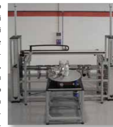
Fig. 2 - Sistema di asservimento automatico in fase di costruzione, interamente realizzato con elementi modulari.
