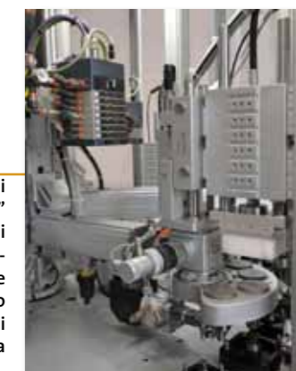
Fig. 3 - Sottoassieme della macchina, adatto al posizionamento di pezzi estratti dalla pressa. E' composto da componenti V-Lock pneumatici e, precisamente, una pinza, un attuatore rotante a 3 posizioni, una slitta di precisione e l'isola di elettrovalvole pneumatiche.
