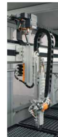
Fig. 3 - Sottoassieme della macchina, adatto al posizionamento di pezzi estratti dalla pressa. E' composto da componenti V-Lock pneumatici e, precisamente, una pinza, un attuatore rotante a 3 posizioni, una slitta di precisione e l'isola di elettrovalvole pneumatiche.
