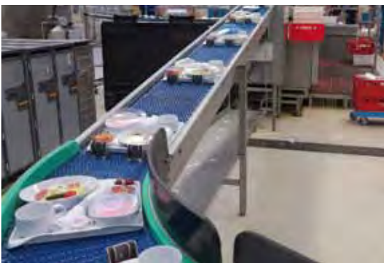
I vassoi vengono trasportati dai nastri trasportatori nell'area di pre-separazione. I materiali residui sono trasferiti a uno scivolo per l'invio ai container dei materiali di scarto.
