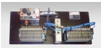
Fig.1 - Pannello elettropneumatico per mezzo di trasporto.
