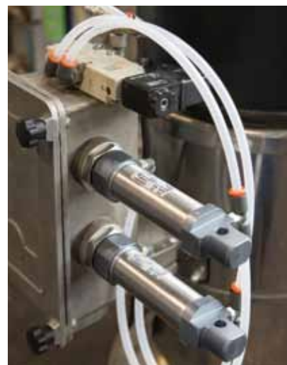
Figura 2 – Esempio di cilindri e valvole Metal Work montati su una pressa.
